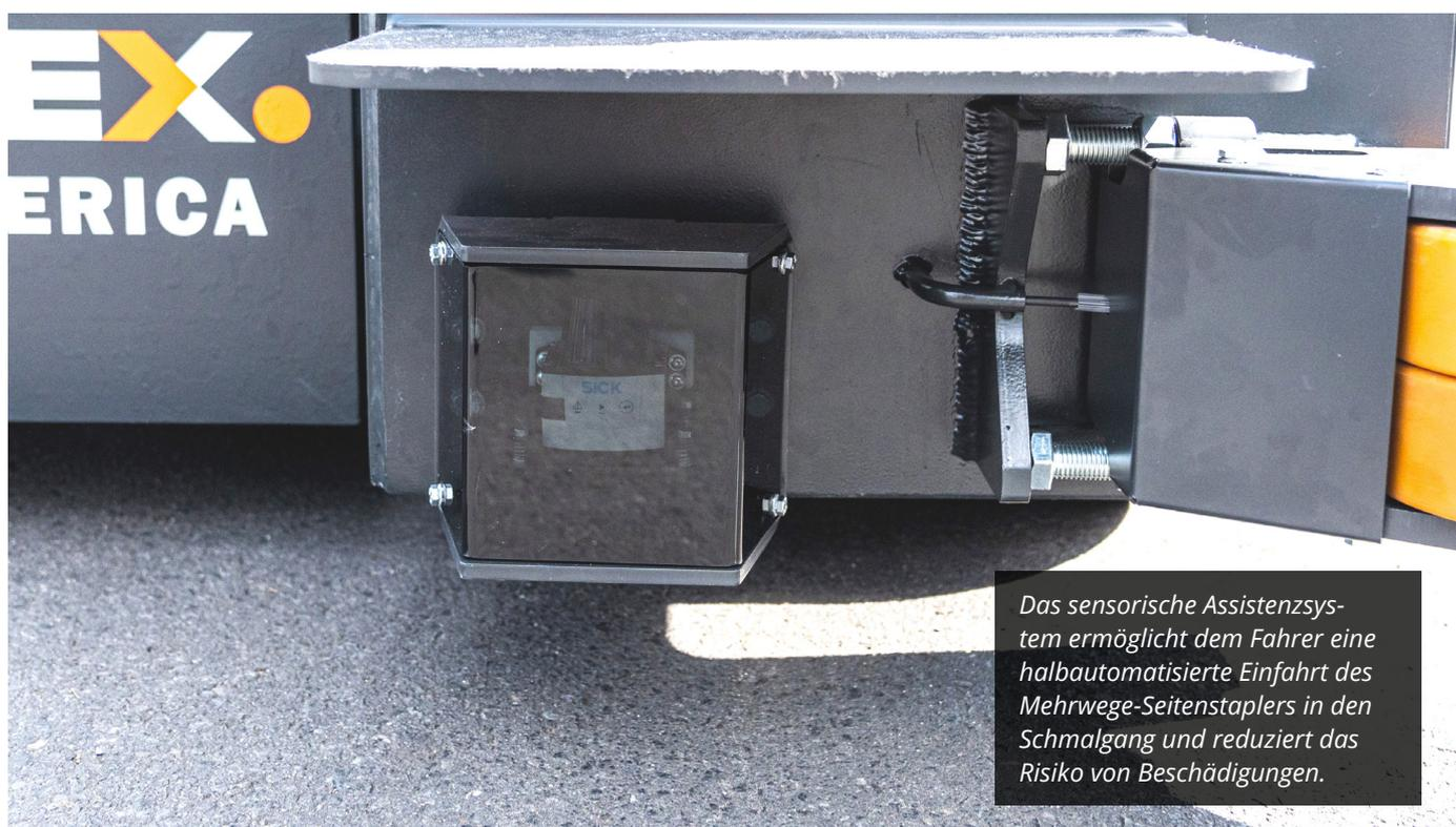
*Das sensorische Assistenzsystem ermöglicht dem Fahrer eine halbautomatisierte Einfahrt des Mehrwege-Seitenstaplers in den Schmalgang und reduziert das Risiko von Beschädigungen.*
